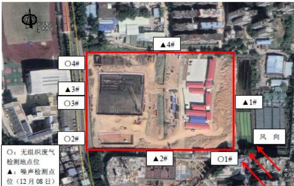
3-3 废气、噪声监测布点图（12月8日）
