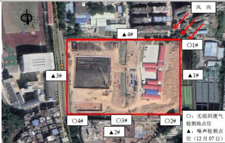
3-2 废气、噪声监测布点图（12月7日）
