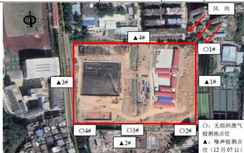
图 6-1 废气、噪声监测布点图（12月7日）
